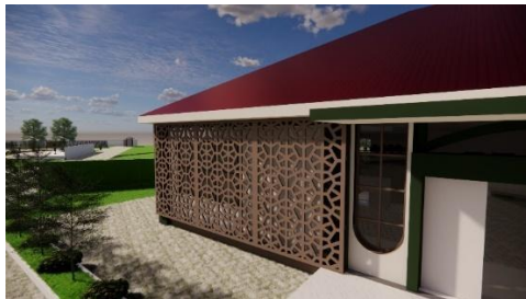
Gambar 18. Secondary Skin Bangunan Penginapan
